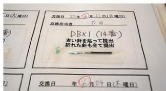
↑ミシン補修部門で使用するミシン針が折れた場合、古い針を全て提出し新しい針と交換する
